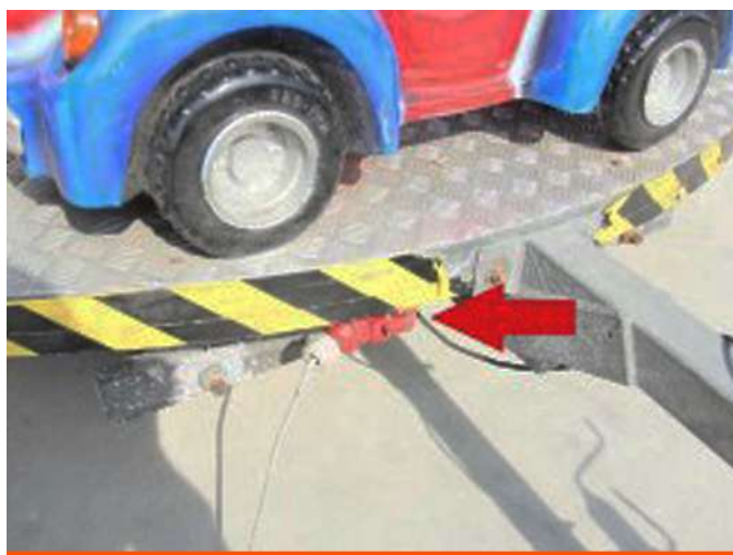
2. Verwijder de kabel van de besturingskast uit de draaimolen
