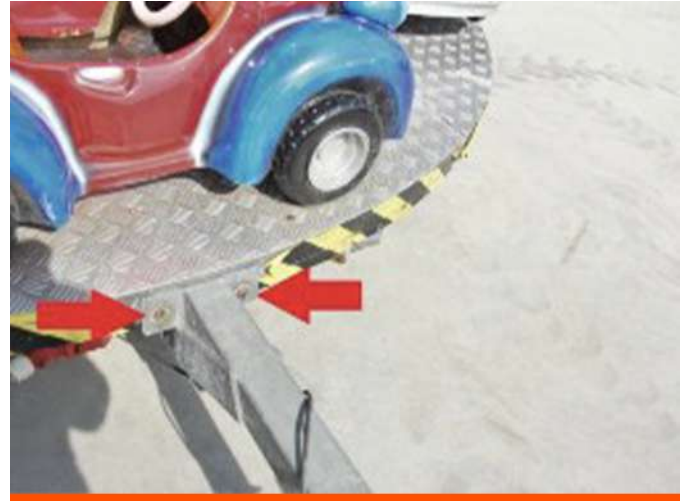
10. Draai de twee bouten en moeren van de metalen balk waar het neuswiel aan vastzit (de dissel), los. Bewaar de bouten en moeren goed
