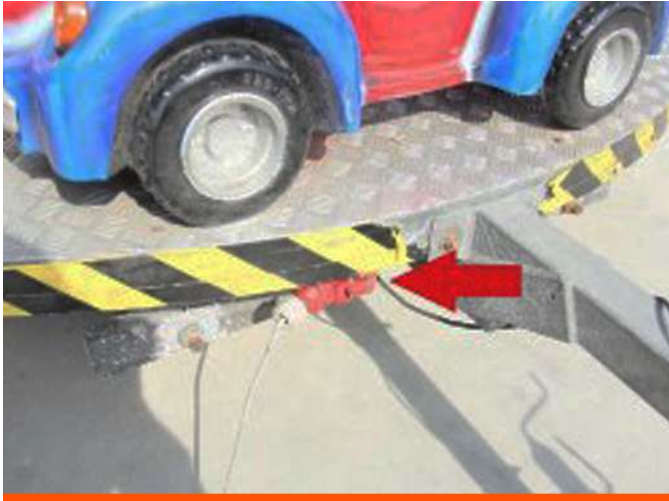
9. Steek de kabel die aan de besturingskast vastzit, in de stroomtoevoer van de draaimolen
