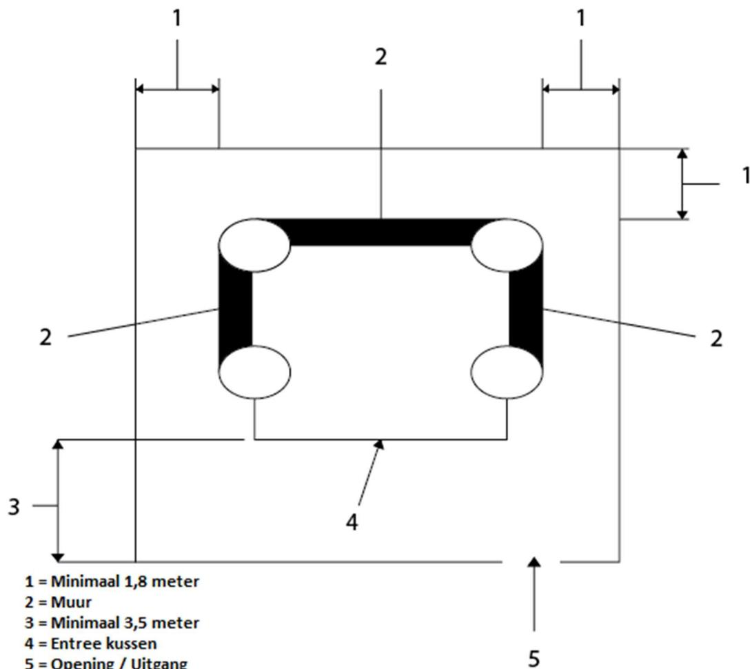
Voor luchtkussens waarvan de hoogte van het hoogste platform hoger is als 360 cm. Dient de vrije ruimte gelijk te zijn aan deze hoogte gedeeld door 2. Bijvoorbeeld hoogste platform 450 cm., dan dient de vrije ruimte 225 cm. te zijn.
